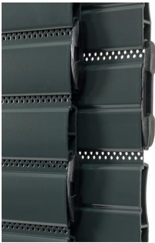
**Les lames sont emboîtées** l'une dans l'autre et bloquées à l'aide d'embouts en polyamide qui facilitent le glissement le long des coulisses.
