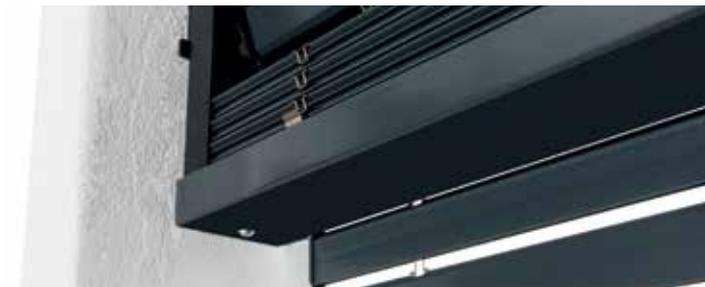
**Lambrequin / Plafonnet** inférieure de couverture de la traverse accueillant le rouleau en aluminium anodisé ou thermolaqué. Hauteur standard de 34 mm. Au-delà de 2000 mm de largeur lumière, la tôle livrée présente une dimension de 84 mm.
